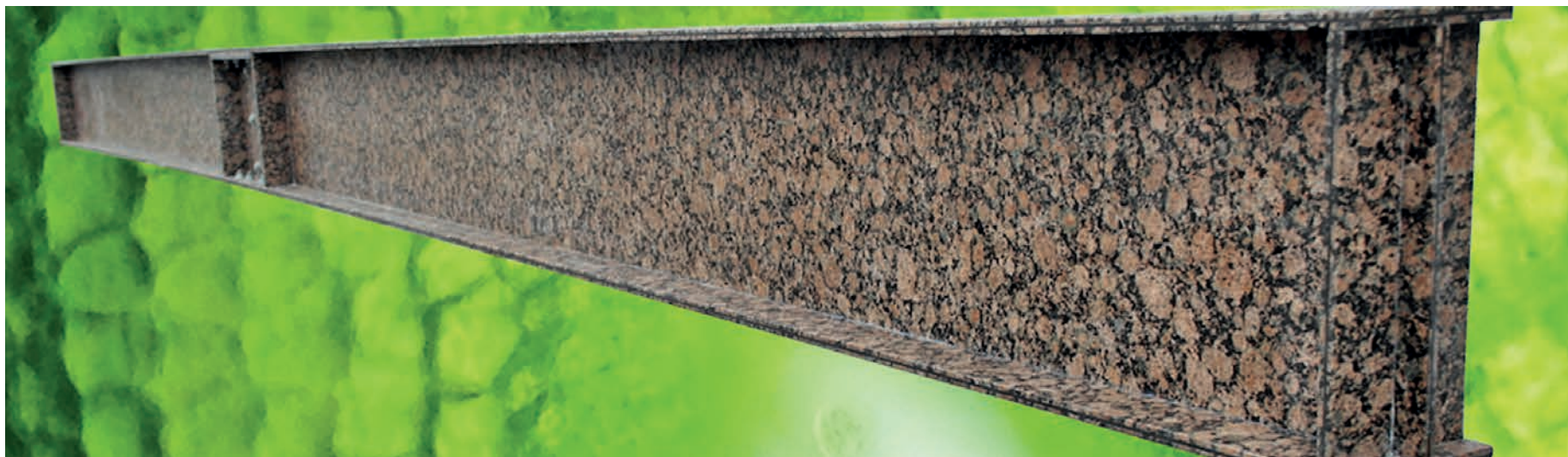
Doppel-T-Träger aus dem Baumaterial CarbonFaserStein (CFS®) als Stahlersatz. Das Baumaterial besteht aus druckfesten Steinplatten, zwischen denen eine zugfeste Schicht aus Carbonfasern angeordnet ist. Der Verbundbaustoff hat ein grosses Leichtbaupotenzial.
